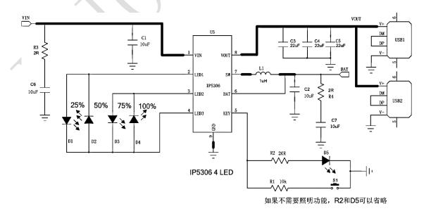
图 1 简化应用原理图(4 LED 指示电量)
