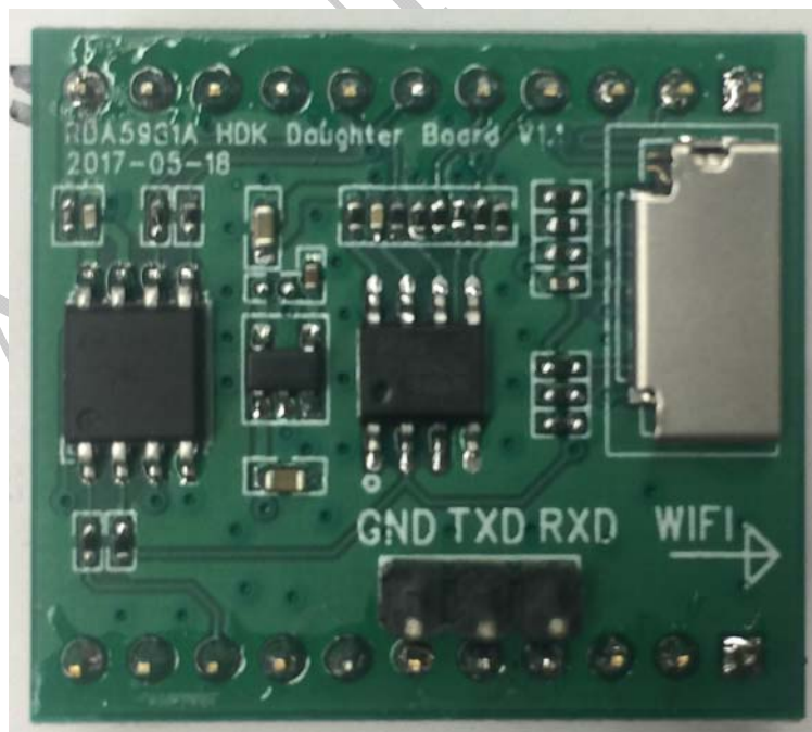
图 29 RDA5981X_HDK 开发板子板
