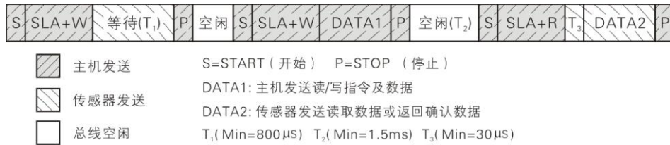
图 14: I 2 C 读写传感器完整示例图
